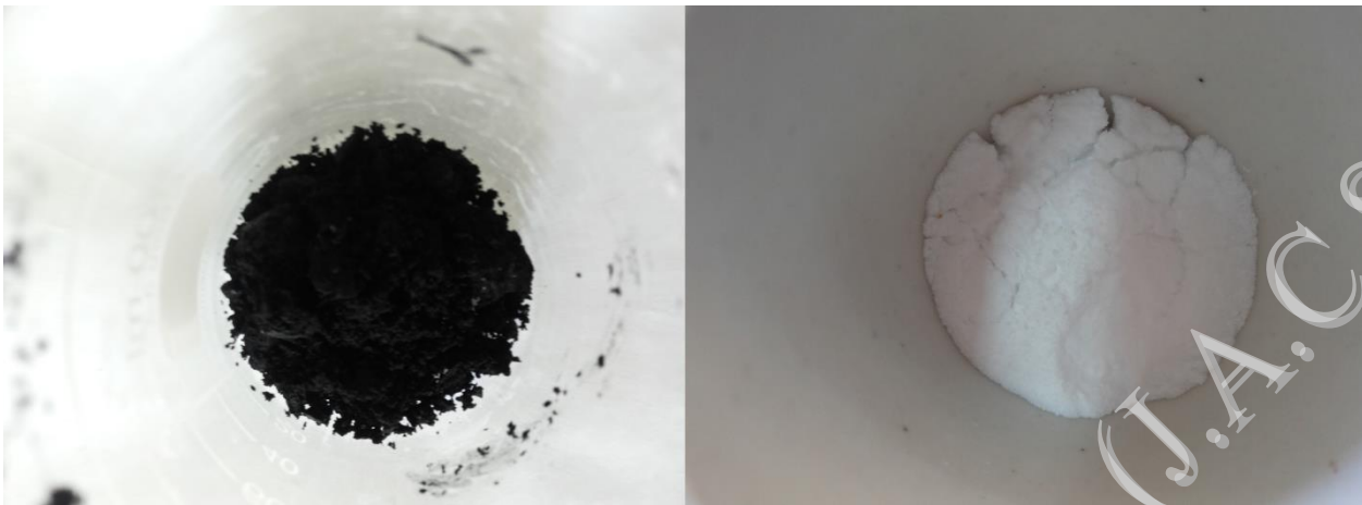
شکل ۱- مزوپور HMS (راست) و نانوکامپوزیت HMS/PPyrr (چپ)
