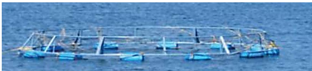
شکل ۷. نمایش قفس CEGI از نوع جمع شونده شناور با قطر ۱۲ متر
